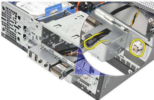
6. Deslice el cable de LED de disco duro y el botón de alimentación a través de la parte frontal del equipo.
