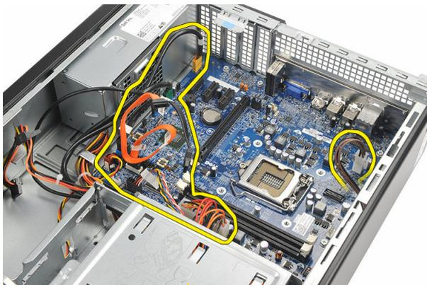
10. Extraiga los tornillos que fijan la placa base al equipo.
