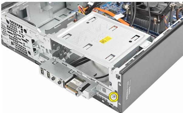
8. Deslice el panel de E/S hacia la parte inferior del equipo y extraiga el panel de E/S del equipo.
