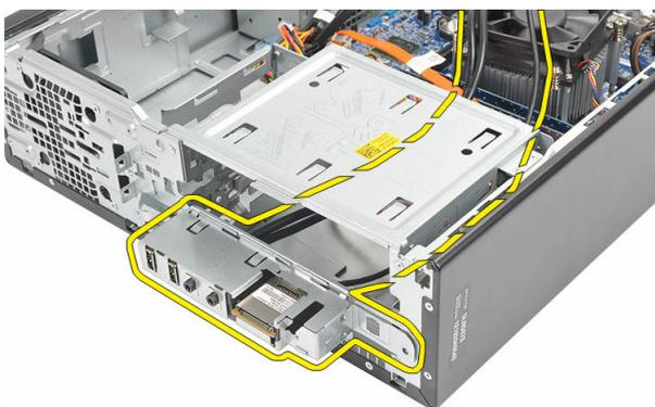
9. Libere los ganchos de seguridad utilizando un destornillador pequeño de cabeza plana y levante el lector de tarjetas SD.
