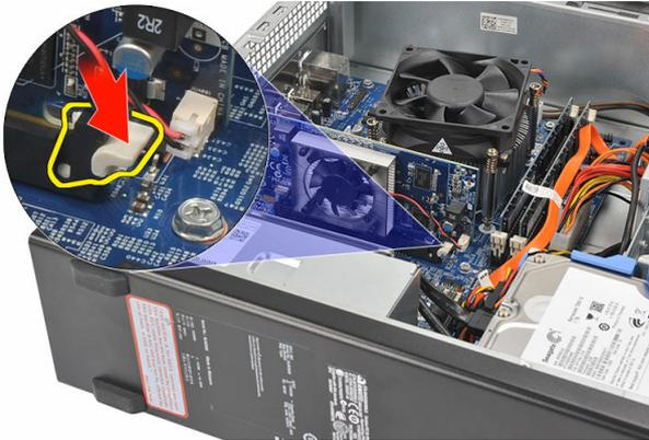
5. Levante la tarjeta de expansión fuera de su conector y extráigala del equipo.
