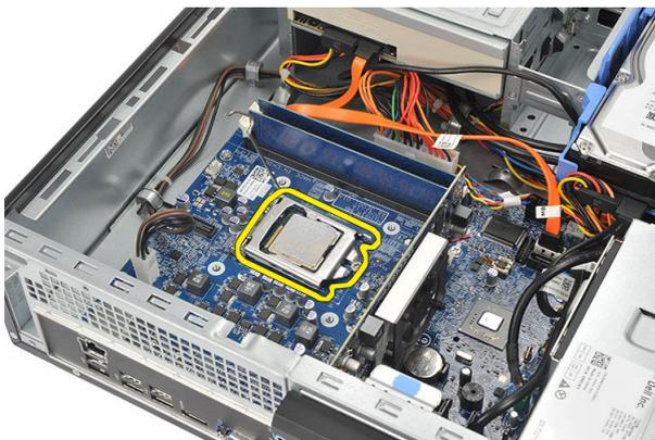
8. Levante el procesador para retirarlo del zócalo y colóquelo en un embalaje antiestático.
