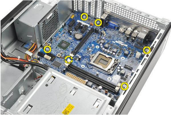
11. Deslice la placa base hacia la parte frontal del equipo y con cuidado, inclínela en un ángulo de 45 grados.
