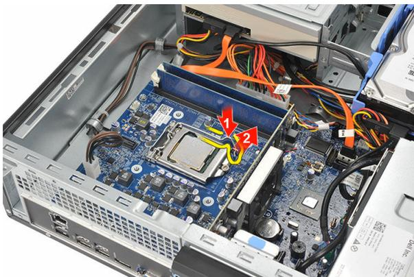
7. Levante la cubierta del procesador.
