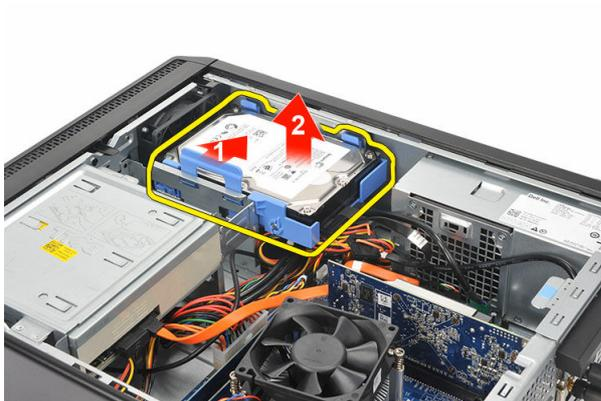
4. Desconecte el cable de datos y el cable de alimentación de la unidad de disco duro.
