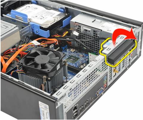
5. Sujete la tarjeta por las esquinas de la parte superior y sáquela de su conector.
