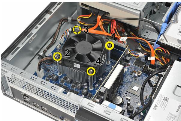
5. Levante el ensamblaje del ventilador y el disipador de calor y extráigalo del equipo.
