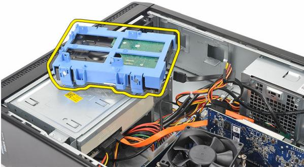
6. Separe las dos lengüetas de la unidad de disco duro y levante la unidad de disco duro para extraerla del soporte de la unidad de disco duro.
