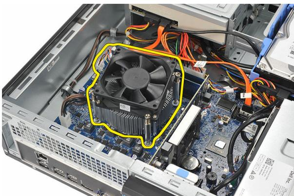
6. Presione la palanca de liberación y muévela hacia fuera para liberarla del gancho de retención que la mantiene fija.
