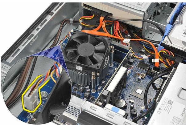
4. Afloje los tornillos cautivos que fijan el ensamblaje del disipador de calor y el abanico a la placa base.
