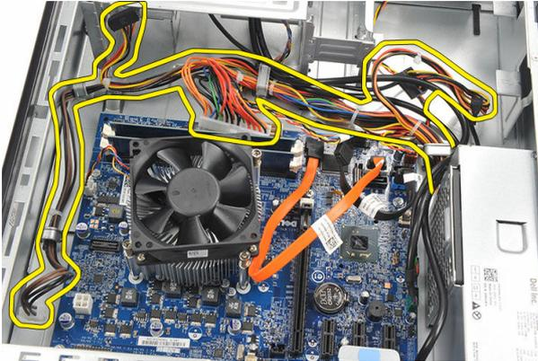
8. Extraiga los tornillos que fijan la fuente de alimentación al equipo.
