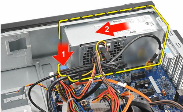
10. Levante y retire el suministro de energía del equipo.
